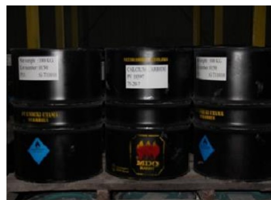
Drum untuk ekspor 100 liter dengan standar negara-negara anggota PBB
